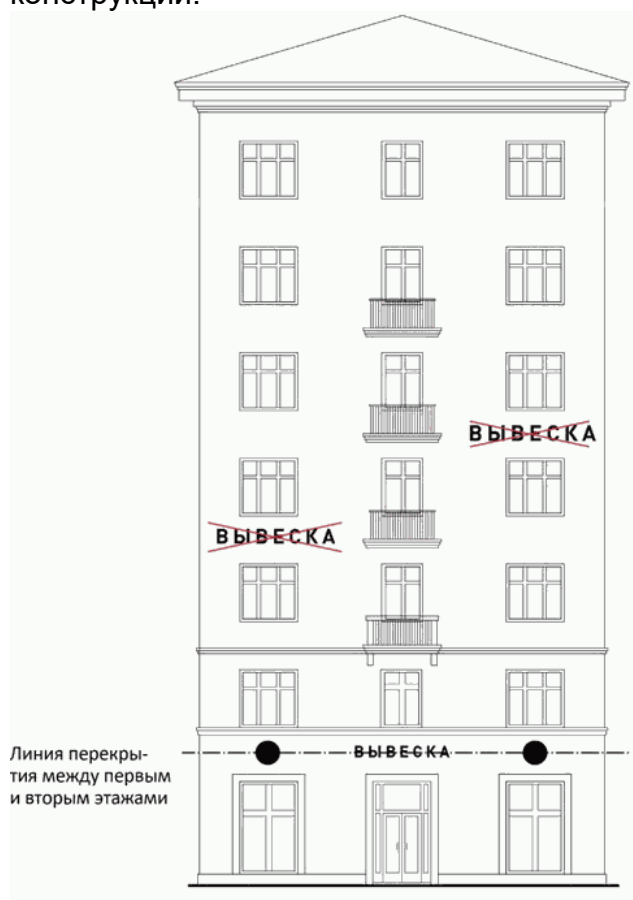
Рисунок 12. Нарушение требований к местам размещения информационных конструкций.
