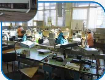
**ОБЩЕСТВО С ОГРАНИЧЕННОЙ ОТВЕТСТВЕННОСТЬЮ "ЗАВОД "ЮНОСТЬ"** введен в действие в 1977 году с годовой проектной мощностью 3,5 млн.шт. высокостабильных, особо точных микроминиатюрных герметичных реле весом от 2гр. Реле электрические слаботочные: РПС-42, 43; РЭС-79,80.
